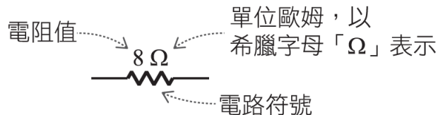
圖 2-1 8\Omega 電阻器的電路符號
