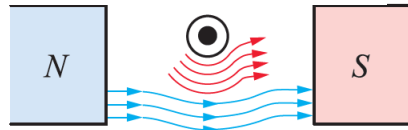
(d) 導體下方磁力線增強
